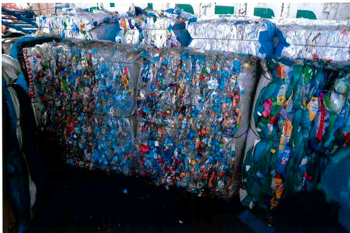
Figura 10: Embalagens de PET triadas, limpas, prensados e empacotadas para venda.
